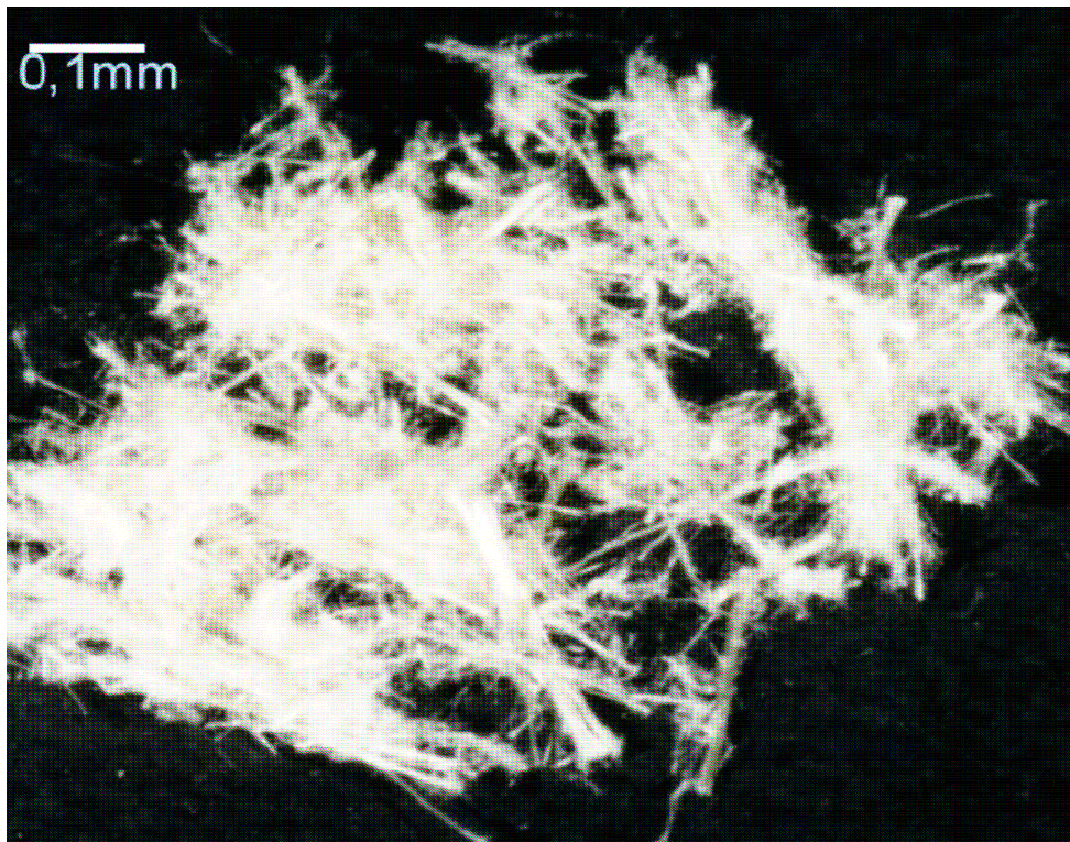
Zdjęcie 1. Azbest chryzotylowy, tzw. twardy, krotkowłóknisty, zawiera \text{CaCO}_3
